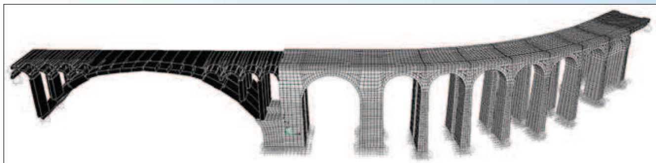
Рис. 5. Математическая модель аркады правого берега и главной арки для расчета по методу конечных элементов
