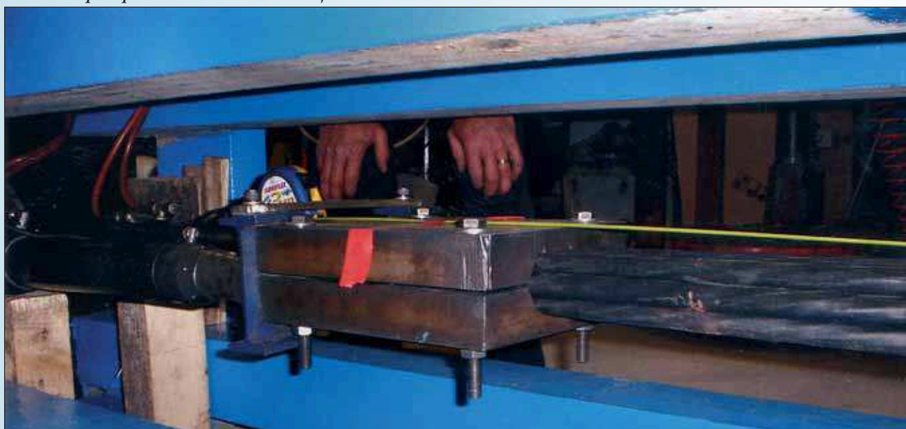
Рис. 8. Лабораторные испытания обжимающей обоймы на сдвиг
