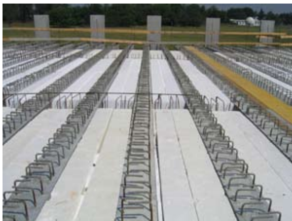
Foto 6 - Le travi principali della g.a. di Pregnana stoccate nel piazzale dello stabilimento di produzione
